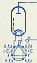
Abb. 3. Sockelschaltung der EY 86 und DY 86
